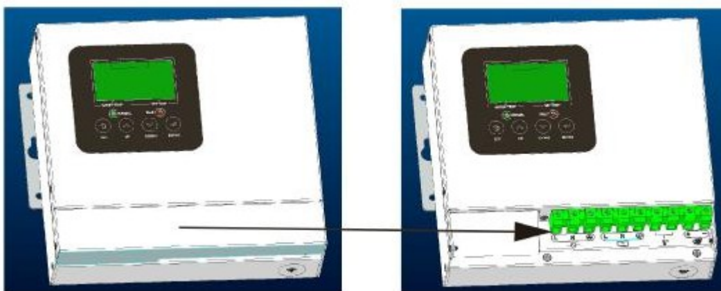
Obrázok: (Ilustrácia znázorňujúca správne odstránenie krytu kabeláže)
